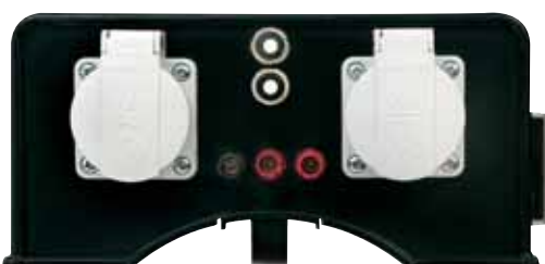
Kit 4 F (Française) ou Kit 4 S (Schuko) - 2 prises monophasées* 16 A + terre + disjoncteur - 3 bornes 12 / 24 V + disjoncteur - 1 voltmètre à "led"
